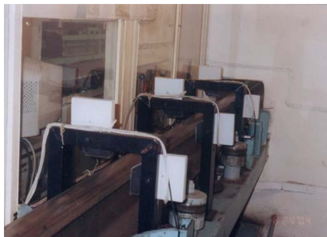
Рис. 3. Элементы системы контроля прямолинейности рельсов на посту рихтовки (слева) и посту ОТК (справа).
