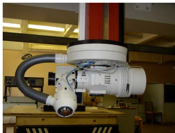
Рис.1. Внешний вид комплекса LSP-2000 (слева) и крупным планом - головка лазерного исполнительного элемента (справа).
