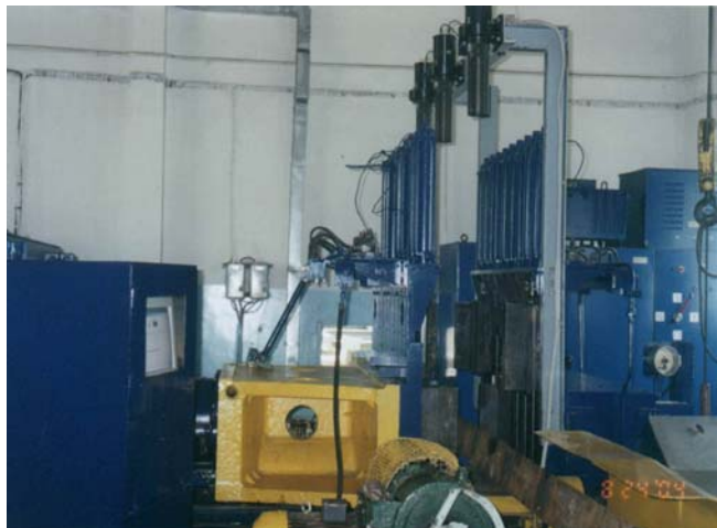
Рис. 3. Элементы системы контроля прямолинейности рельсов на посту рихтовки (слева) и посту ОТК (справа).
