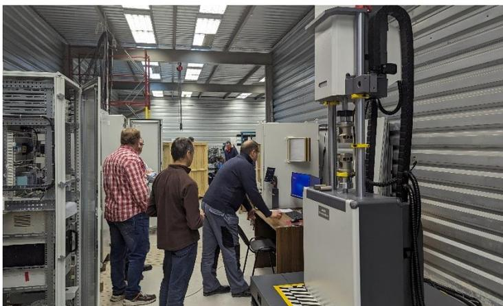
Испытательная машина предназначена для растяжения и сжатия образцов с одновременным скручиванием непосредственно в ходе эксперимента с использованием синхротронного излучения. Эксперименты такого типа называются *in situ*.
